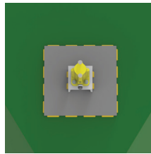
Soldadura adecuada de un canal de montaje corto con placas de refuerzo
